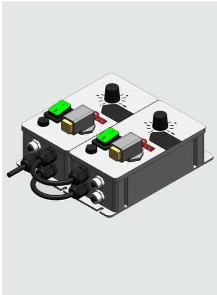
Die Steuerungen vom Typ FARR-S-1 bestehen aus zwei Phasenanschnitt-Regelgeräten vom Typ FAR-S-1 zur getrennten Ansteuerung von Linear- bzw. Wendelförderer. Die Leistungsverstellung der Förderer erfolgt durch die Verstellung der dem Förderer zugeführten Netzspannung. Als Zusatzfunktion bieten die Regelgeräte vom Typ FARR-S-1 eine integrierte Füllstandsteuerung (Stauschaltung). Die Bedienung des Regelgerätes erfolgt über interne Potentiometer zur Einstellung der Fördergeschwin-
