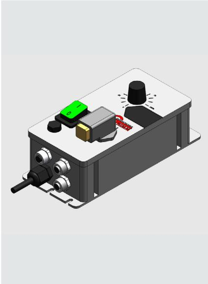
Die Regelgeräte Typ FAR-S-1 arbeiten nach dem Phasenanschnittprinzip, wobei die Leistungsverstellung des Förderers durch die Verstellung der dem Förderer zugeführten Netzspannung erfolgt.
