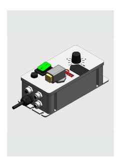
Die Regelgeräte Typ FAR-S-1 arbeiten nach dem Phasenanschnittprinzip, wobei die Leistungsverstellung des Förderers durch die Verstellung der dem Förderer zugeführten Netzspannung erfolgt.
